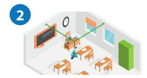
Placer l'ensemble vers le milieu de la pièce à hauteur des voies respiratoires et au moins à une distance d'1 mètre des parois pendant une durée de 4,5 jours
